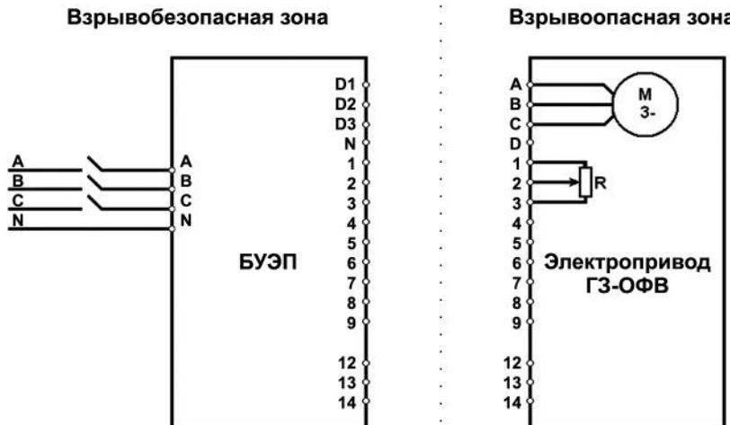
Рис.5 Блок-схема подключения БУЭП к электроприводу
