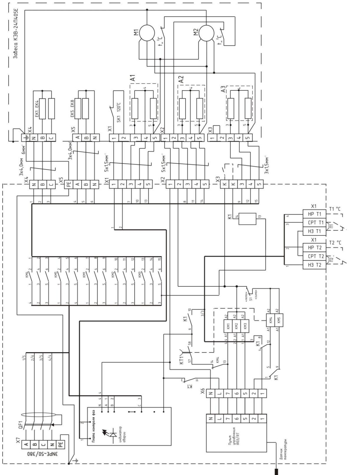
Рис. 5. Электрическая схема подключения занавес без БКУ-Е
