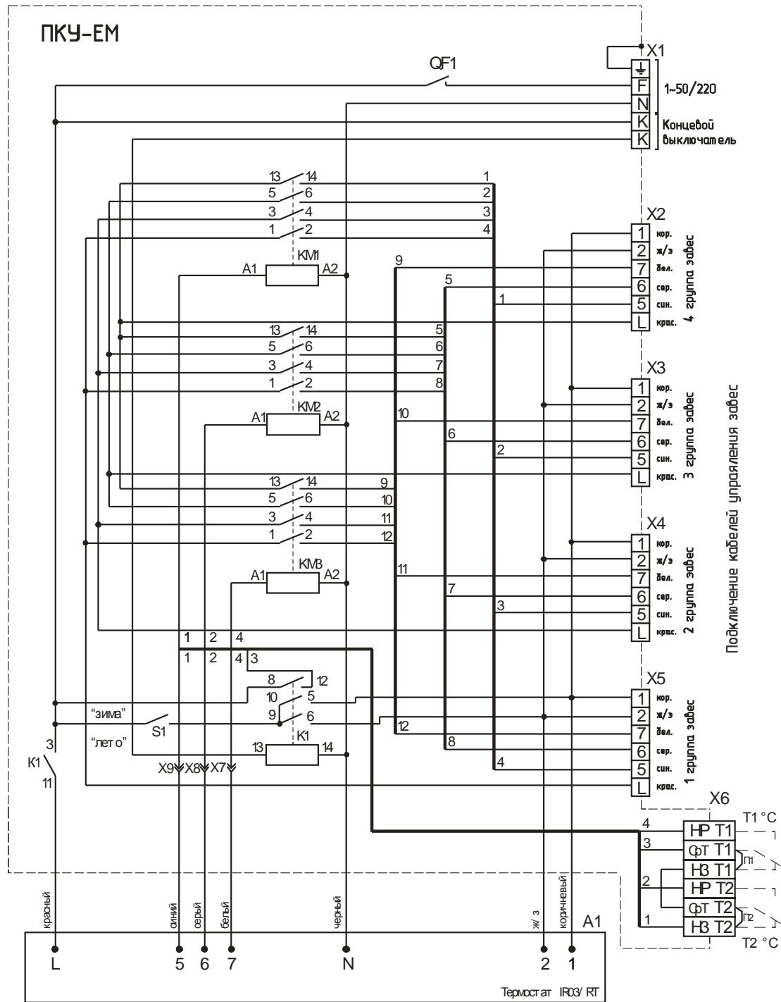
**Рис. 8.** Электрическая схема Блока-Е подключения концевого выключателя к завесам с электрическим источником тепла.
