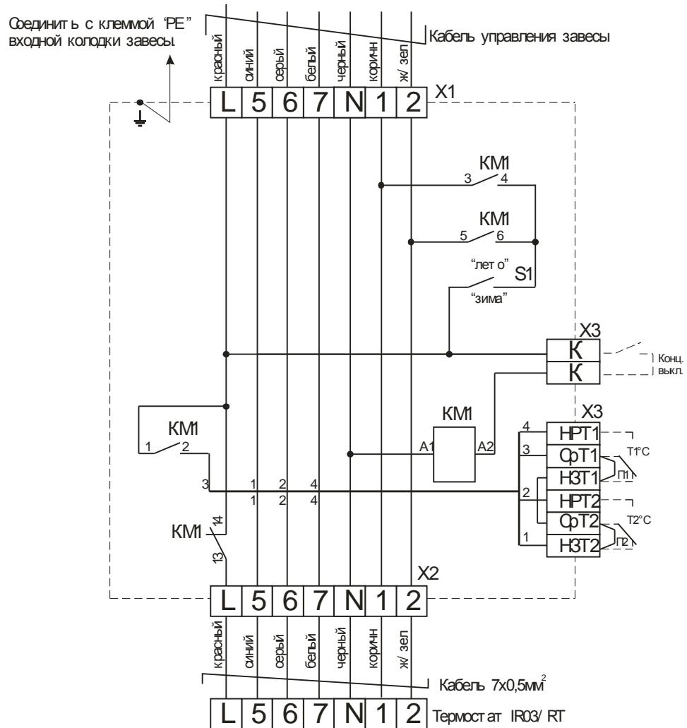
**Рис. 9.** Электрическая схема подключения пульта управления
