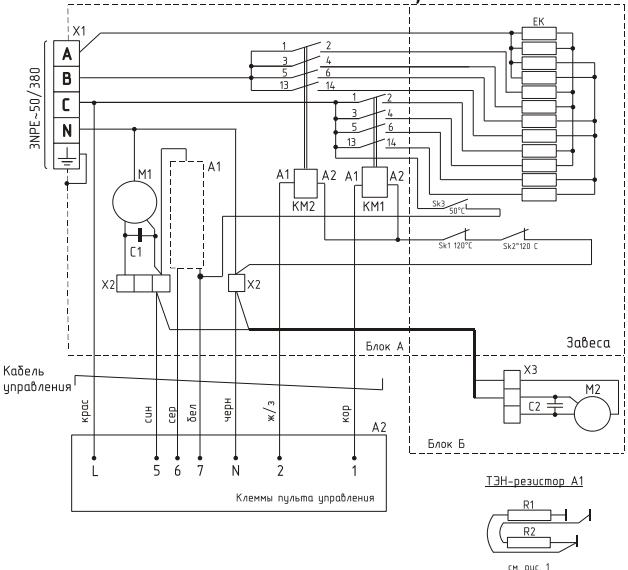
Рис. 7. Электрическая схема ПКУ-ЕМ
