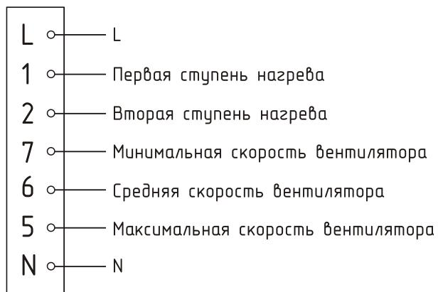
Рис. 5. Электрическая схема подключения завес без БКУ (П4050W\*, П4060W)
