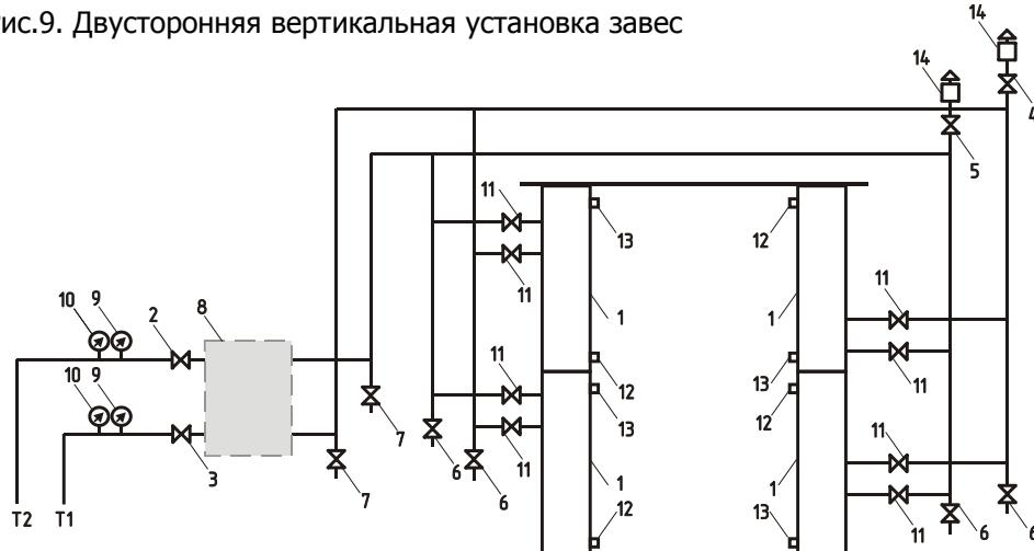
1 – тепловые завесы/ 2, 3 – шаровые краны смесительного узла/ 4, 5 – краны воздухоотводчиков/ 6,7 – сливные краны/ 8 – смесительный узел/ 9 – термометры/ 10 – манометры/
