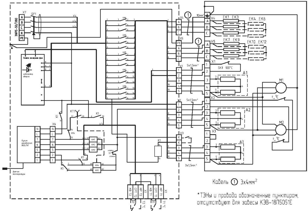
Рис. 4. Электрическая схема занес КЭВ-П5051Е без БКУ
