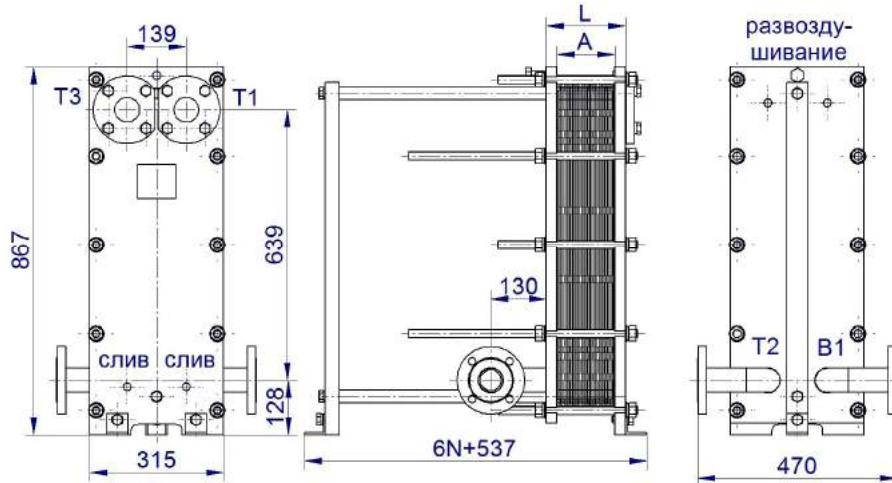
Рисунок 33- Трехходовой теплообменник ВТ-012, DN50
