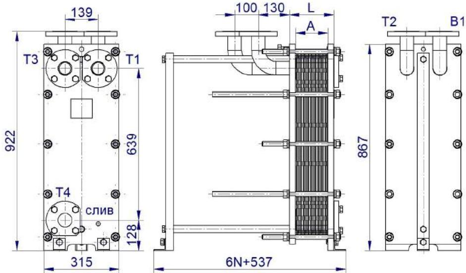
Рисунок 30- Двухходовой теплообменник ВТ-012, DN50 с циркуляционной линией Ц
