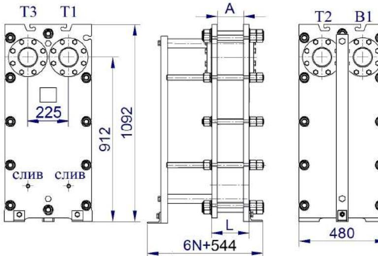
Рисунок 64- Двухходовой теплообменник ВТ-022 без циркуляционной линии
