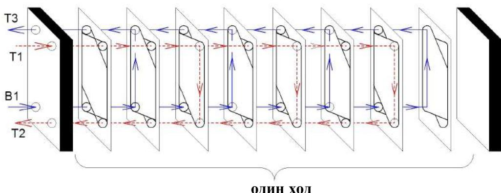
Рисунок 67- Компоновка пластин одноходового теплообменника с расположением патрубков на неподвижной плите(1)
