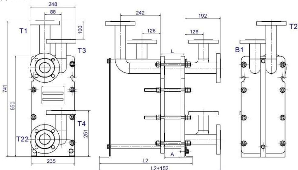
Рисунок 17- Двухходовой теплообменник ВТ-006, DN50 для двухступенчатой смешанной схемы горячего водоснабжения МГВ
