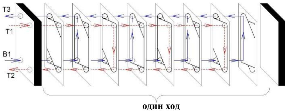
Рисунок 68- Компоновка пластин одноходового теплообменника с расположением патрубков с разных сторон теплообменника
