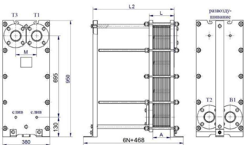
Рисунок 51- Трехходовой теплообменник ВТ-015
