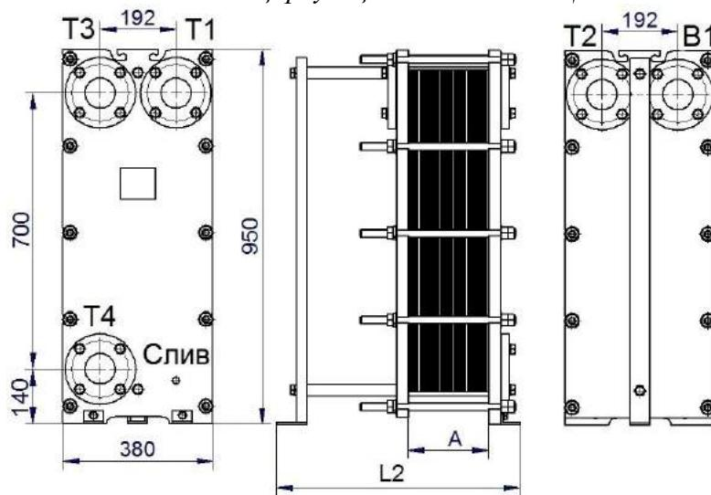
Рисунок 54- Двухходовой теплообменник ВТ-015М, DN50 и DN 65 с циркуляционной линией Ц
