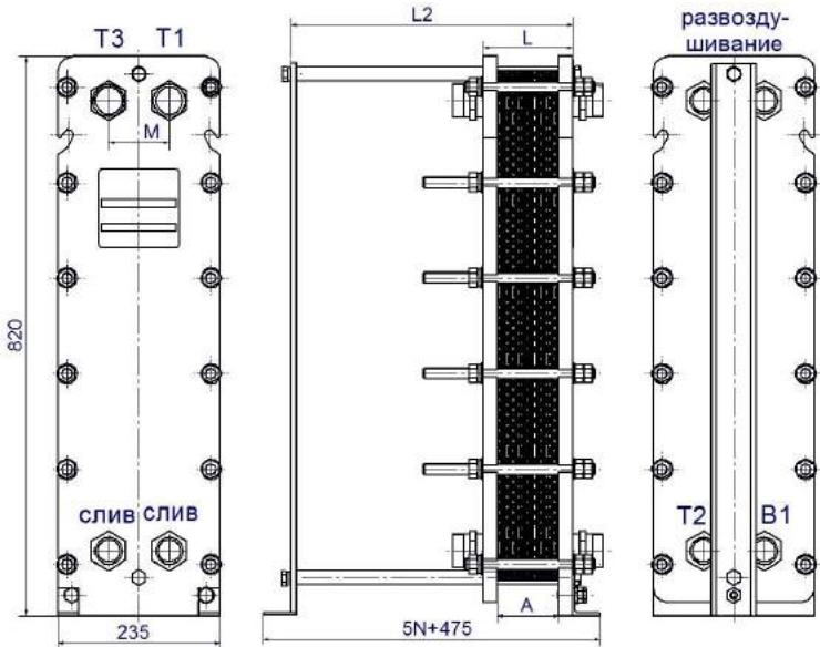
Рисунок 23- Трехходовой теплообменник ВТ-010, DN32
