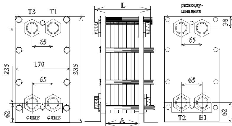
**Рисунок 7- Трехходовой теплообменник ВТ-002**
