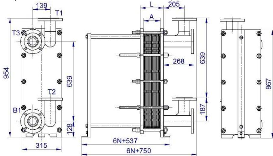
Рисунок 34- Одноходовой теплообменник ВТ-012, DN80 с расположением патрубков на неподвижной плате (1)
