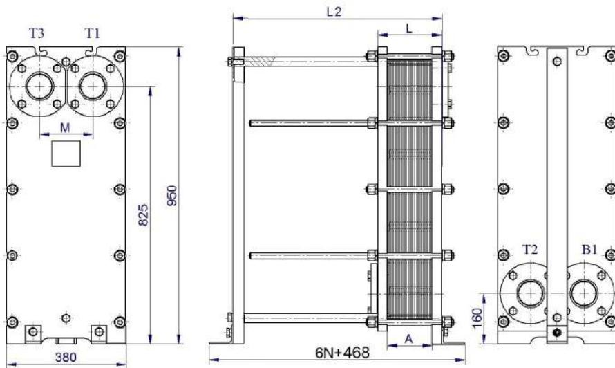
Рисунок 47- Одноходовой теплообменник ВТ-015 с расположением патрубков с разных сторон теплообменника (2)
