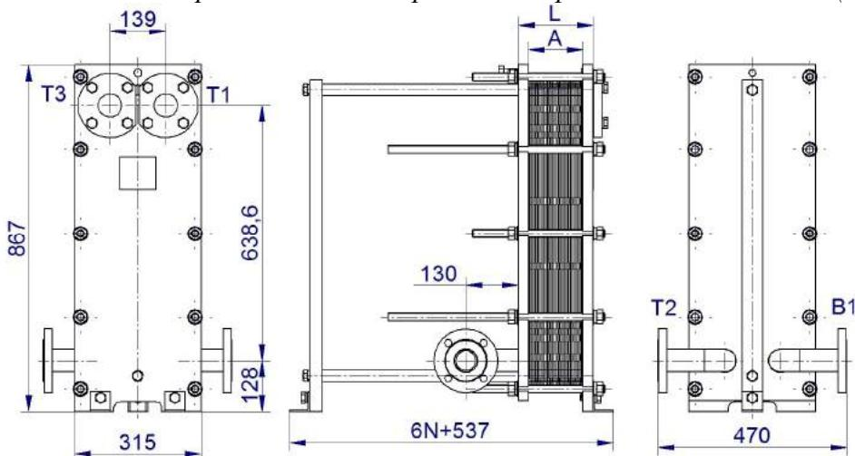
Рисунок 29- Одноходовой теплообменник ВТ-012, DN50 с расположением патрубков с разных сторон теплообменника(2)
