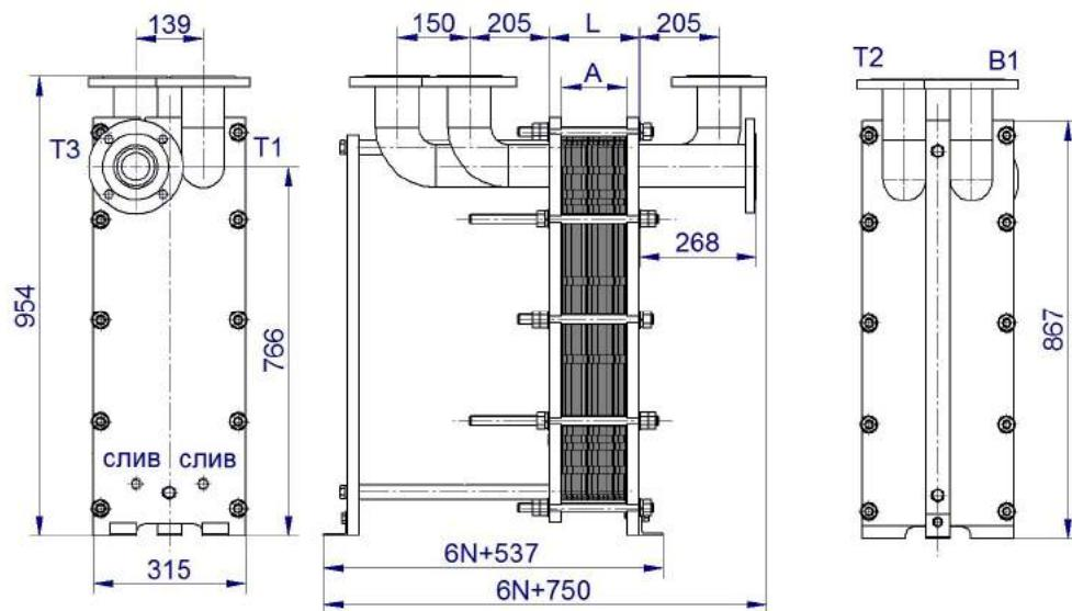
Рисунок 36- Двухходовой теплообменник ВТ-012, DN80 без циркуляционной линии
