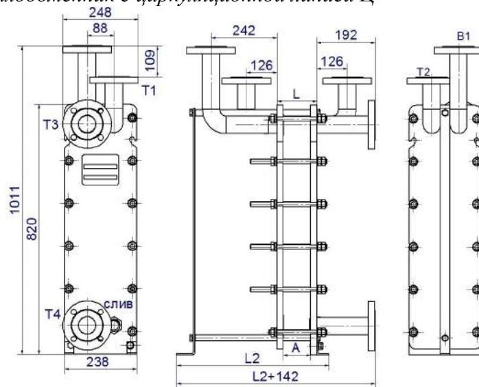
Рисунок 25- Двухходовой теплообменник ВТ-010, DN50 с циркуляционной линией Ц
