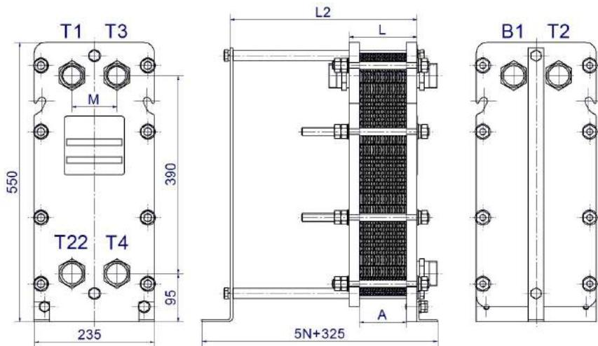
Рисунок 12- Двухходовой теплообменник ВТ-006, DN32 для двухступенчатой смешанной схемы горячего водоснабжения МГВ
