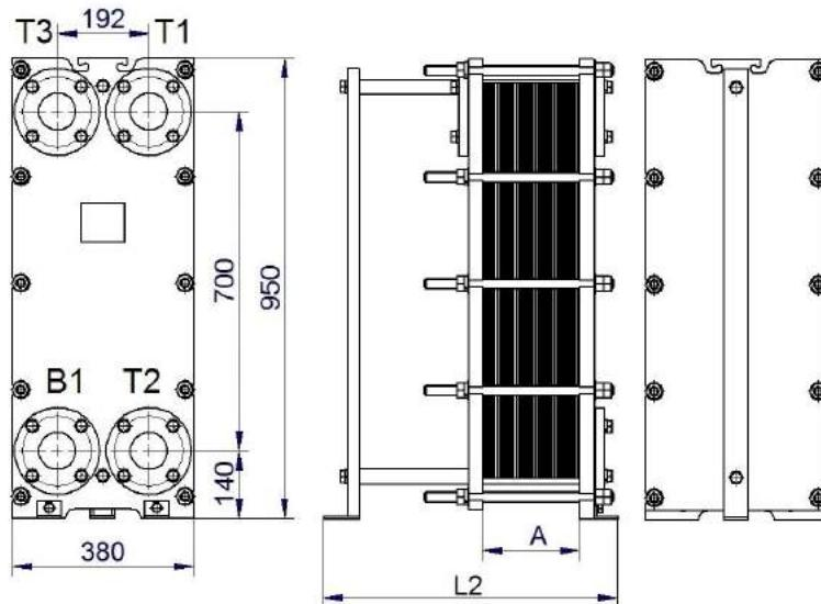
Рисунок 52- Одноходовой теплообменник ВТ-015М, DN50 и DN 65 все патрубки на неподвижной плите (1)
