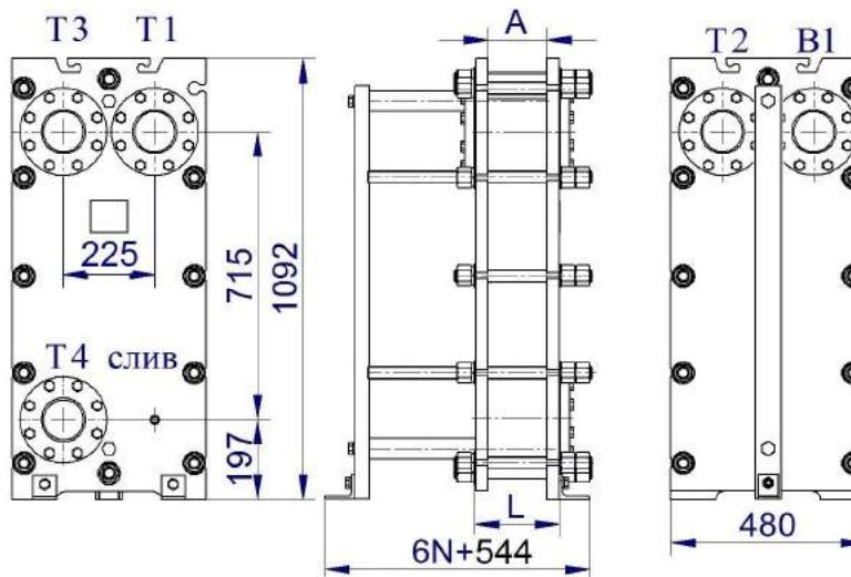
Рисунок 63- Двухходовой теплообменник ВТ-022 с циркуляционной линией Ц
