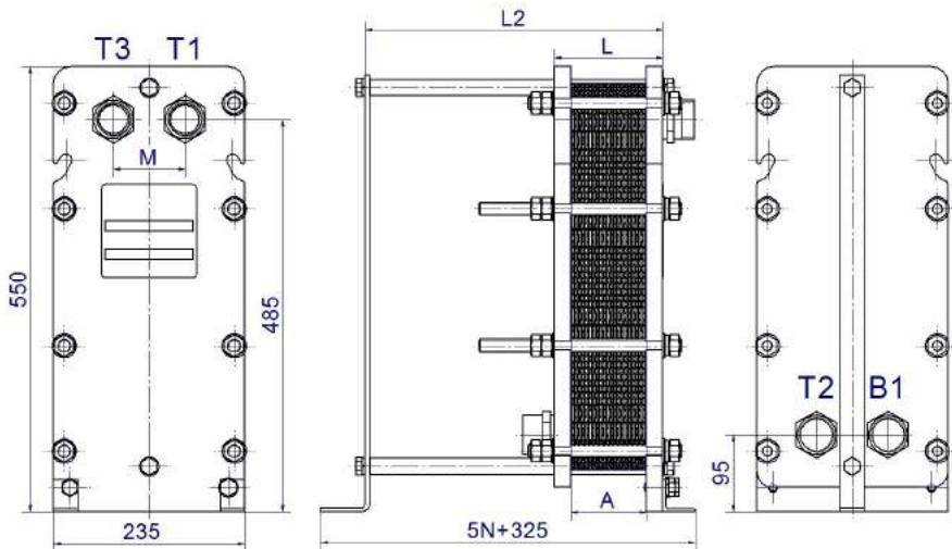
Рисунок 9- Одноходовой теплообменник ВТ-006, DN32 с расположением ниппелей с разных сторон теплообменника(2)
