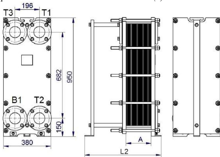
**Рисунок 57- Одноходовой теплообменник ВТ-015М, DN80 все патрубки на неподвижной плите (1)**
