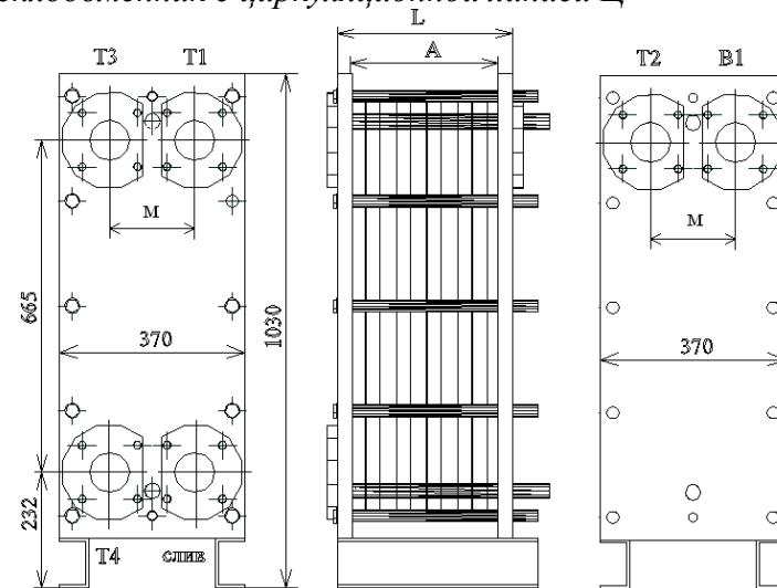
Рисунок 42- Двухходовой теплообменник ВТ-013 с циркуляционной линией Ц
