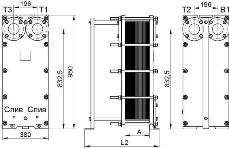
Рисунок 59- Двухходовой теплообменник ВТ-015М, DN80 без циркуляционной линии
