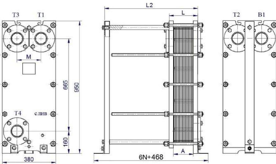
Рисунок 48- Двухходовой теплообменник ВТ-015 с циркуляционной линией Ц
