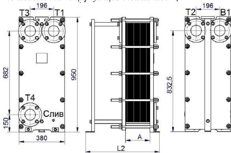
**Рисунок 58- Двухходовой теплообменник ВТ-015М, DN80 с циркуляционной линией Ц**
