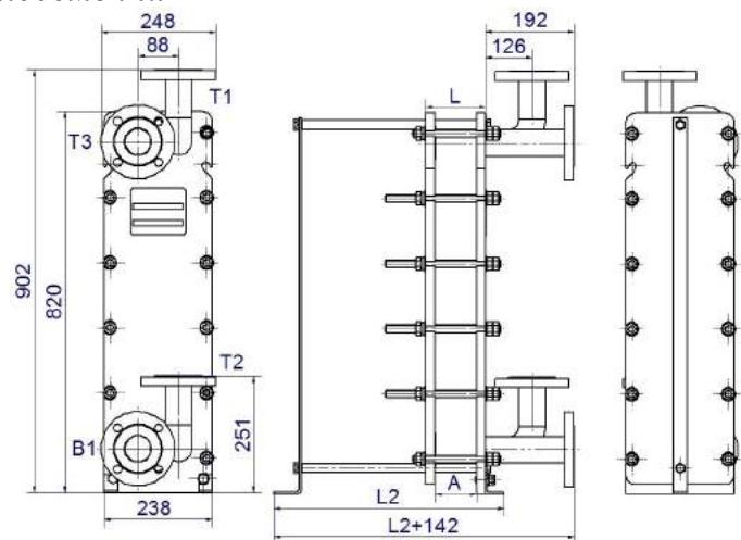
Рисунок 24- Одноходовой теплообменник ВТ-010, DN50
