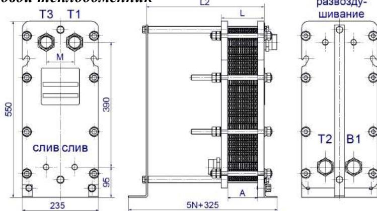
Рисунок 13- Трехходовой теплообменник ВТ-006, DN32
