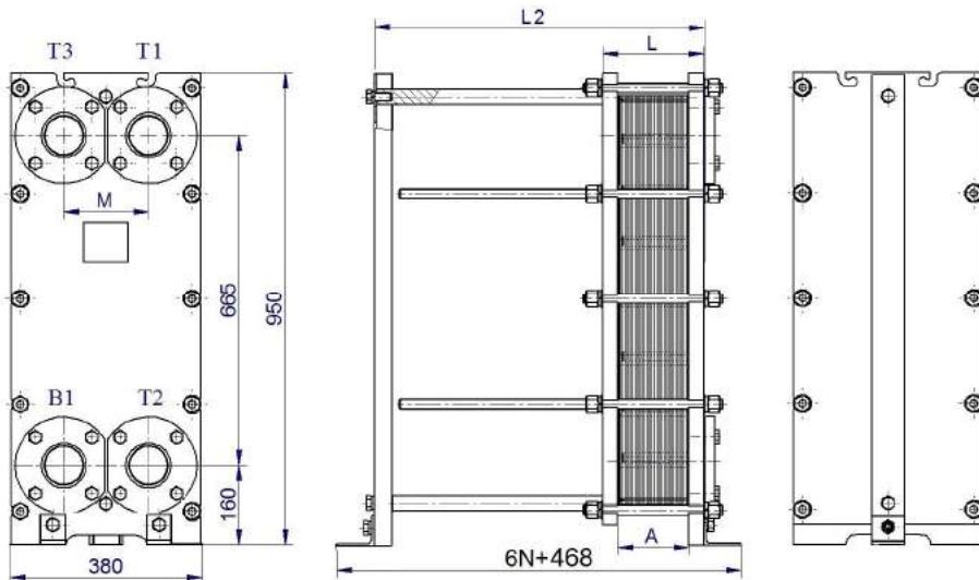
Рисунок 46- Одноходовой теплообменник ВТ-015 с расположением патрубков на неподвижной плите (1)
