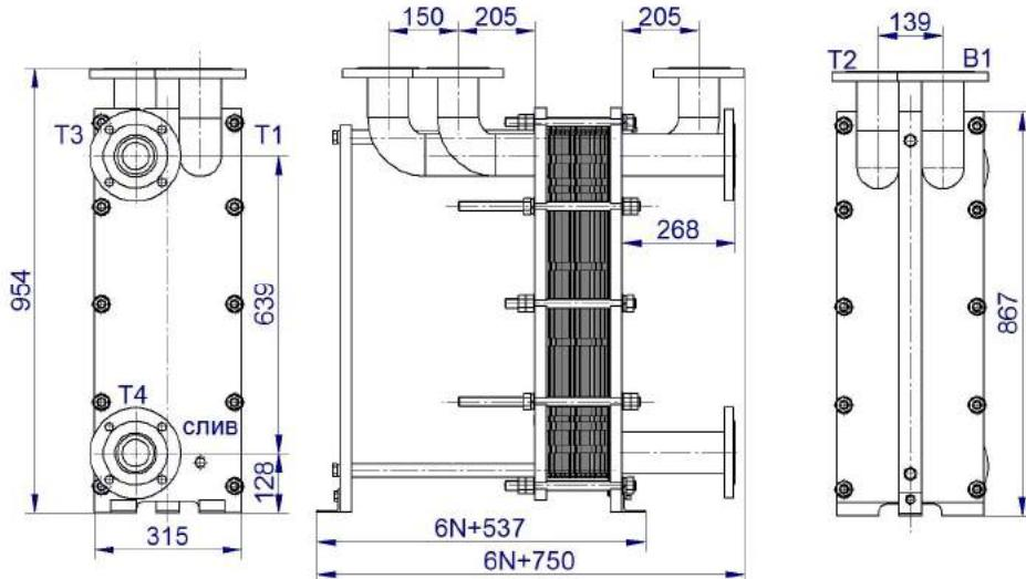
Рисунок 35- Двухходовой теплообменник ВТ-012, DN80 с циркуляционной линией Ц
