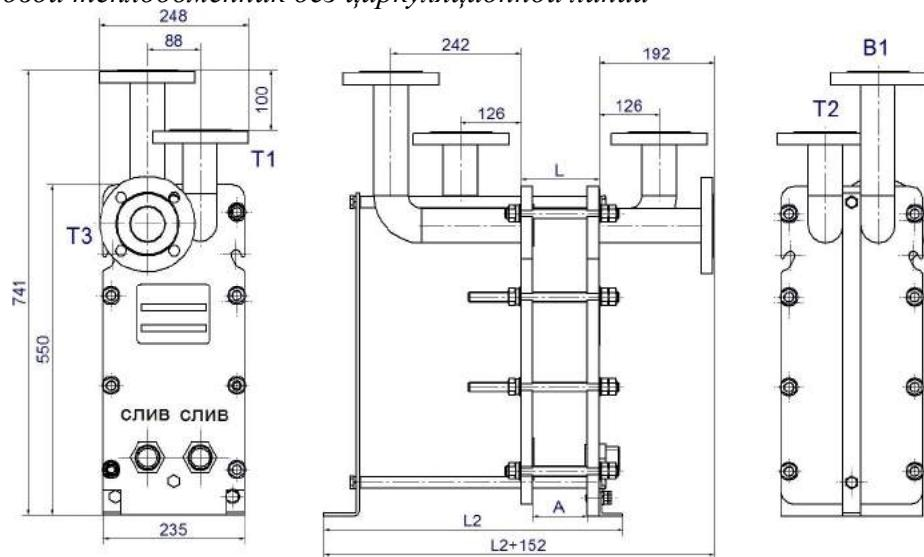
Рисунок 16- Двухходовой теплообменник ВТ-006, DN50 без циркуляционной линии
