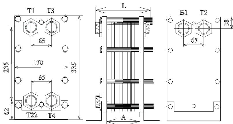
**Рисунок 6- Двухходовой теплообменник ВТ-002 для двухступенчатой смешанной схемы горячего водоснабжения МГВ**
