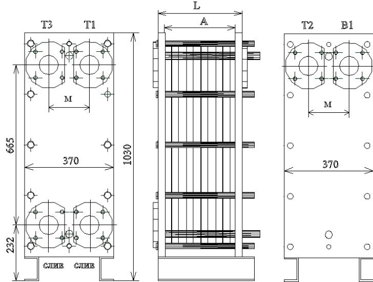
Рисунок 43- Двухходовой теплообменник ВТ-013 без циркуляционной линии
