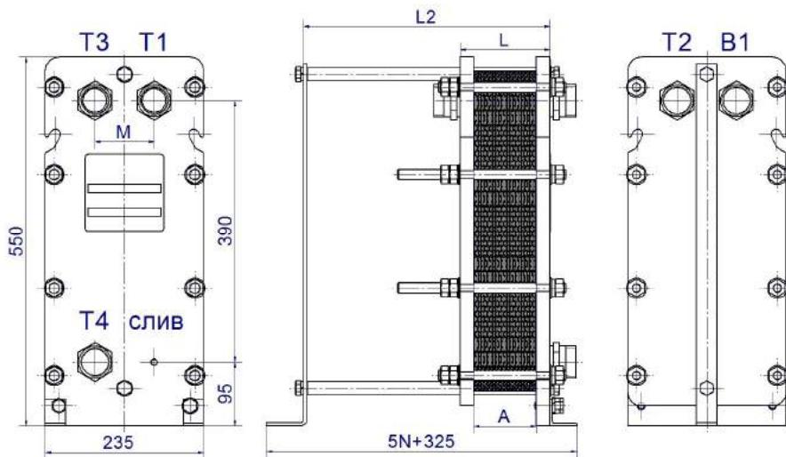
Рисунок 10- Двухходовой теплообменник ВТ-006, DN32 с циркуляционной линией Ц
