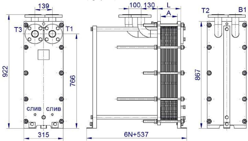
Рисунок 31- Двухходовой теплообменник ВТ-012, DN50 без циркуляционной линии
