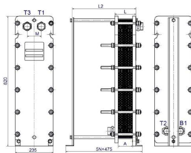
Рисунок 19- Одноходовой теплообменник ВТ-010, DN32 с расположением пниппелей на обеих плитах теплообменника(2)
