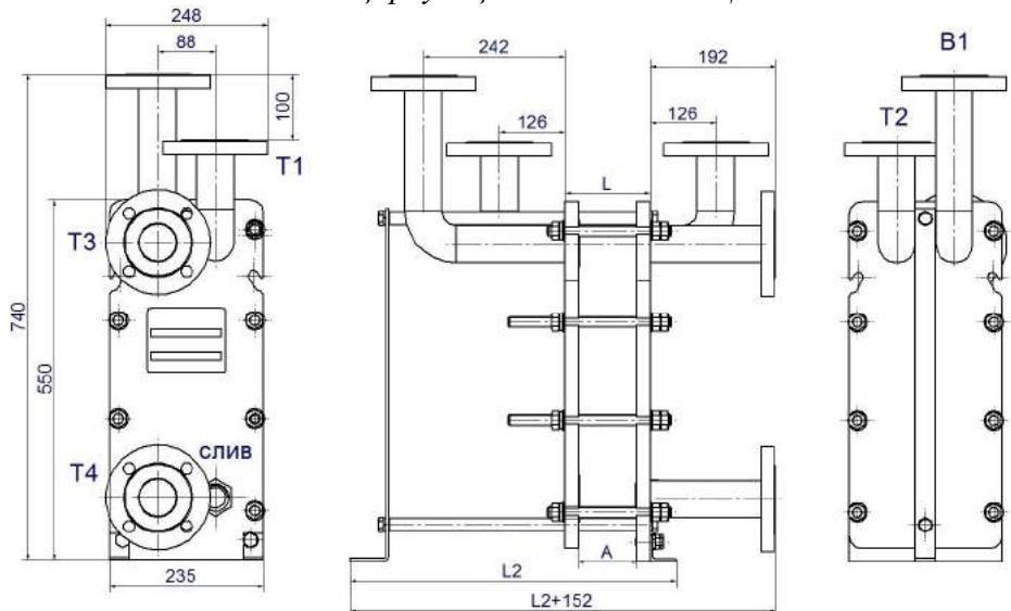
Рисунок 15- Двухходовой теплообменник ВТ-006, DN50 с циркуляционной линией Ц
