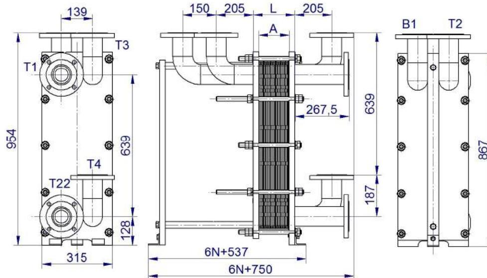
Рисунок 37- Двухходовой теплообменник ВТ-012, DN80 для двухступенчатой смешанной схемы горячего водоснабжения МГВ
