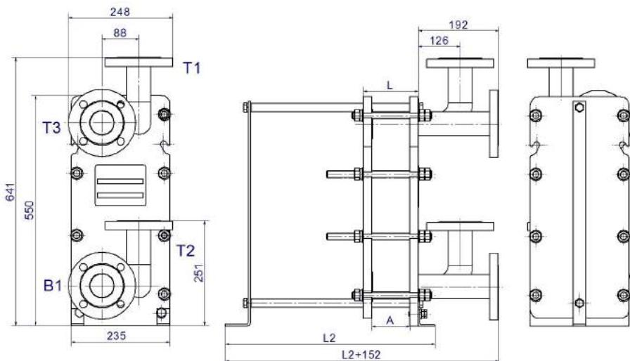
Рисунок 14- Одноходовой теплообменник ВТ-006, DN50
