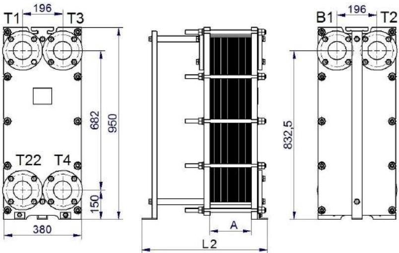
Рисунок 60- Двухходовой теплообменник ВТ-015М, DN80 для двухступенчатой смешанной схемы горячего водоснабжения МГВ
