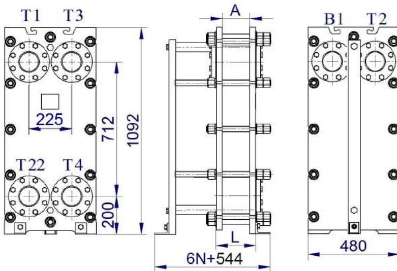
Рисунок 65- Двухходовой теплообменник ВТ-022 для двухступенчатой смешанной схемы горячего водоснабжения МГВ
