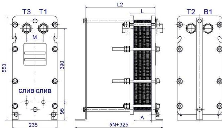
Рисунок 11- Двухходовой теплообменник ВТ-006, DN32 без циркуляционной линии
