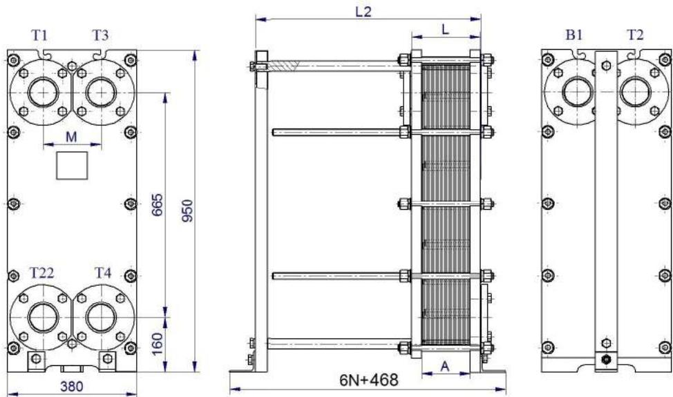
Рисунок 50- Двухходовой теплообменник ВТ-015 для двухступенчатой смешанной схемы горячего водоснабжения МГВ
