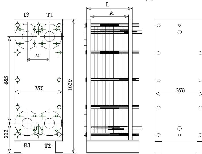
Рисунок 40- Одноходовой теплообменник ВТ-013 с расположением патрубков на неподвижной плите (1)
