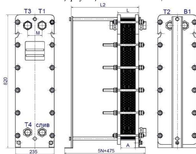
Рисунок 20- Двухходовой теплообменник ВТ-010, DN32 с циркуляционной линией Ц
