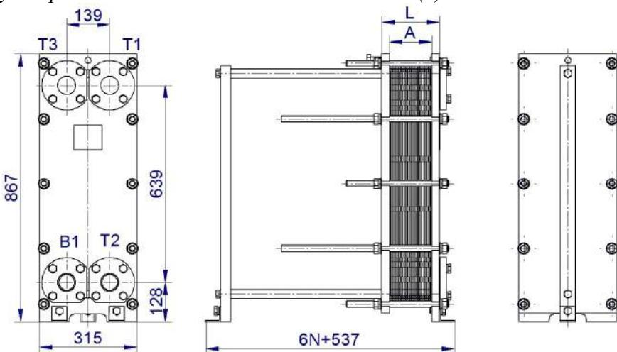
Рисунок 28- Одноходовой теплообменник ВТ-012, DN50 с расположением патрубков на неподвижной плате (1)
