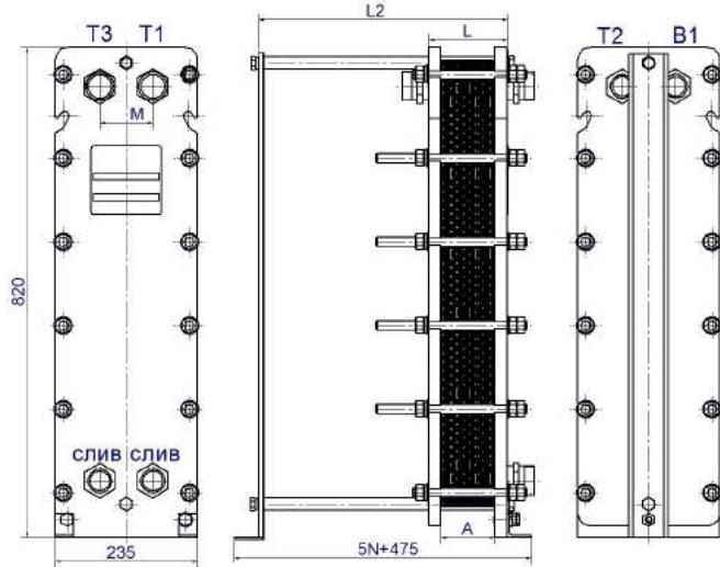
Рисунок 21- Двухходовой теплообменник ВТ-010, DN32 без циркуляционной линии
