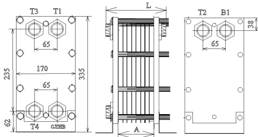
Рисунок 4- Двухходовой теплообменник ВТ-002 с циркуляционной линией Ц
