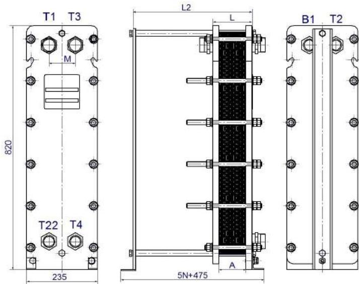
Рисунок 22- Двухходовой теплообменник ВТ-010, DN32 для двухступенчатой смешанной схемы горячего водоснабжения МГВ
