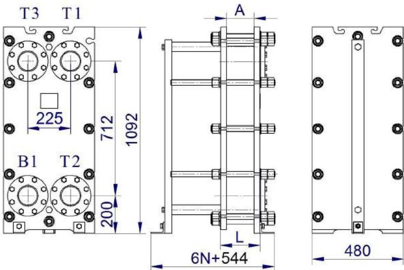
Рисунок 61- Одноходовой теплообменник ВТ-022 с расположением патрубков на неподвижной плите (1)
