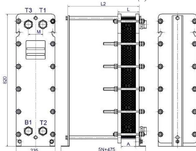
Рисунок 18- Одноходовой теплообменник ВТ-010 , DN32 с расположением ниппелей на неподвижной плате(1)
