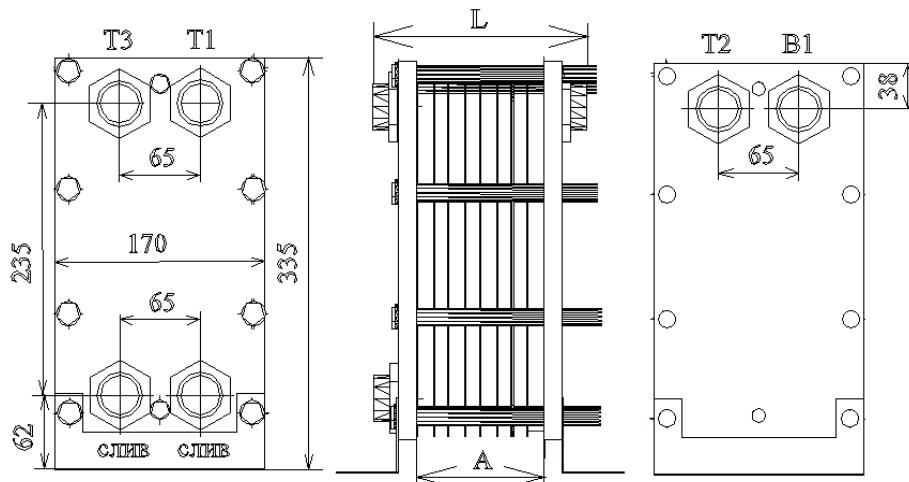
Рисунок 5- Двухходовой теплообменник ВТ-002 без циркуляционной линии
