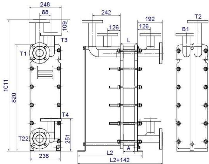
Рисунок 27- Двухходовой теплообменник ВТ-010, DN50 для двухступенчатой смешанной схемы горячего водоснабжения МГВ
