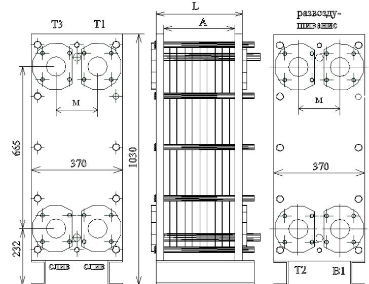
Рисунок 45- Трехходовой теплообменник ВТ-013
