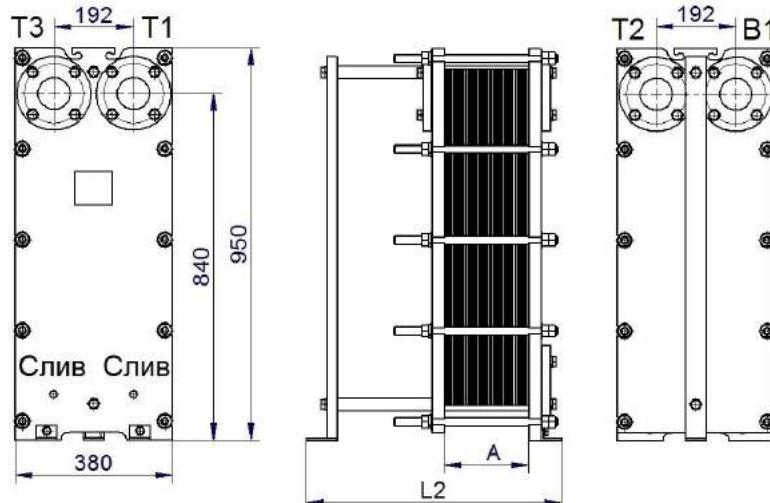
Рисунок 55- Двухходовой теплообменник ВТ-015М, DN50 и DN 65 без циркуляционной линии
