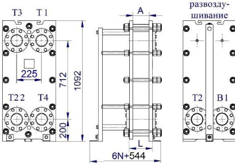
Рисунок 66- Трехходовой теплообменник ВТ-022
