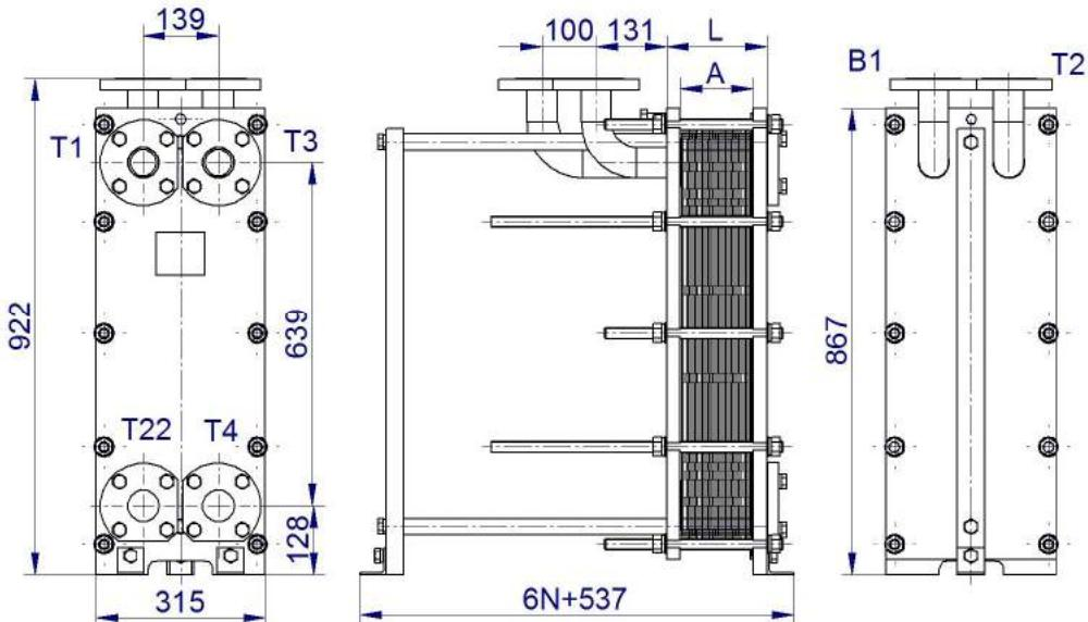
Рисунок 32- Двухходовой теплообменник ВТ-012, DN50 для двухступенчатой смешанной схемы горячего водоснабжения МГВ
