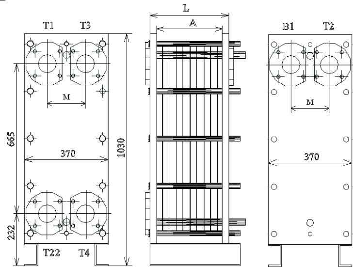
Рисунок 44- Двухходовой теплообменник ВТ-013 с выносной опорой для двухступенчатой смешанной схемы горячего водоснабжения МГВ
