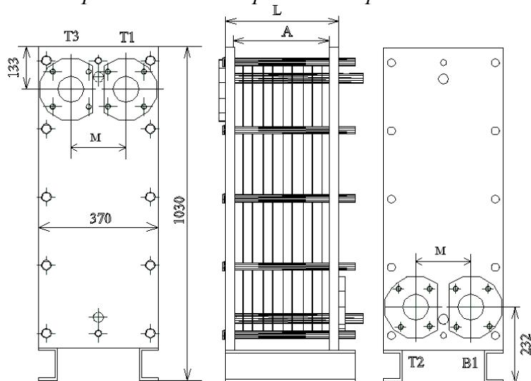
Рисунок 41- Одноходовой теплообменник ВТ-013 с расположением патрубков с разных сторон теплообменника (2)
