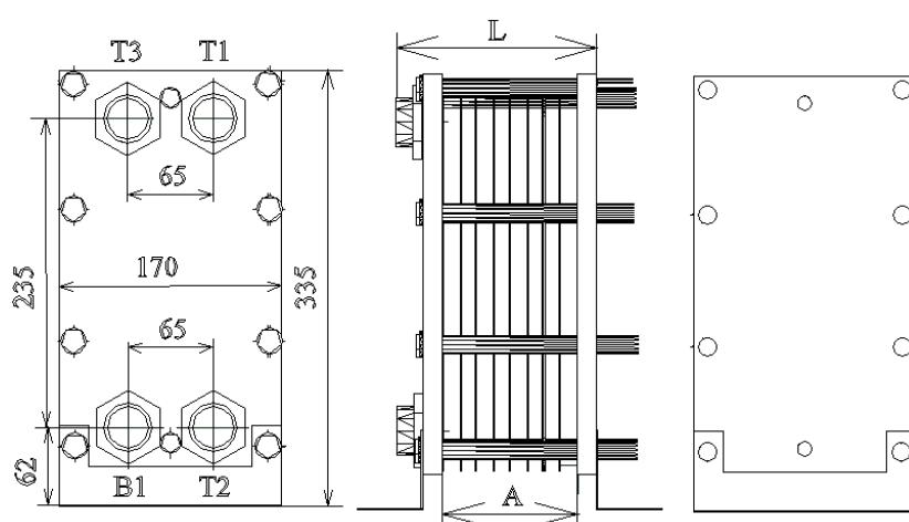
Рисунок 2- Одноходовой теплообменник ВТ-002 с расположением ниппелей на неподвижной плите(1)
