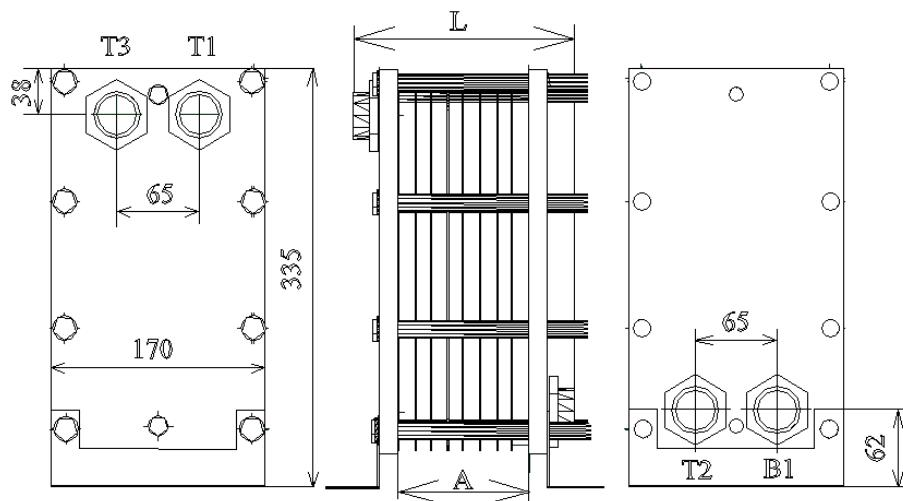
Рисунок 3-Одноходовой теплообменник ВТ-002 с расположением ниппелей
