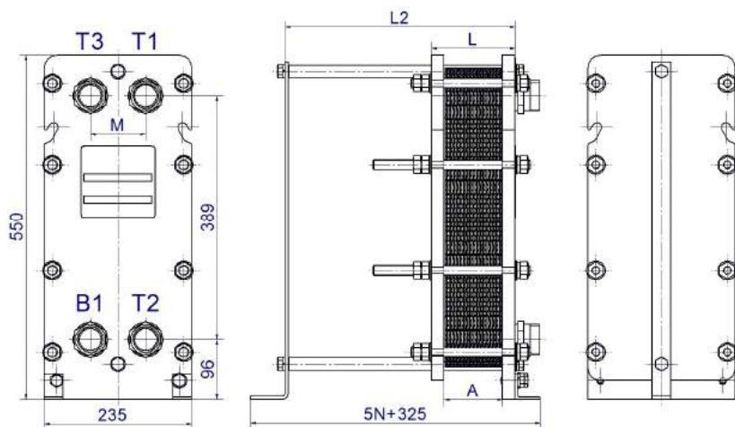
**Рисунок 8- Одноходовой теплообменник ВТ-006, DN32 с расположением ниппелей на неподвижной плате(1)**
