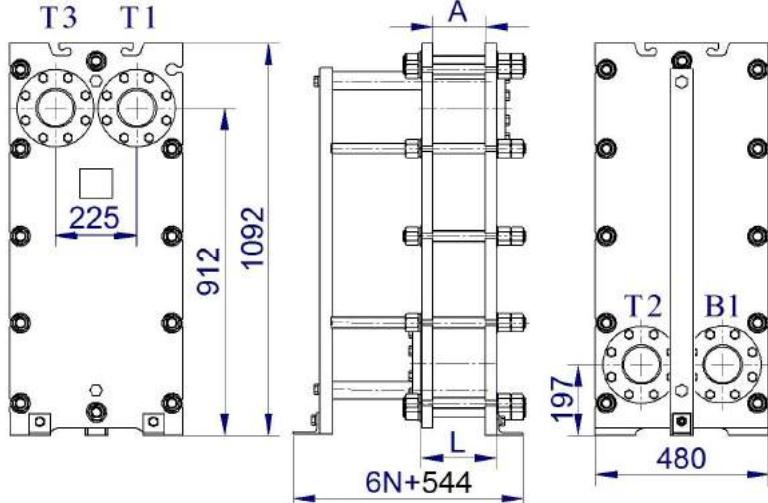
Рисунок 62- Одноходовой теплообменник ВТ-022 с расположением патрубков с разных сторон теплообменника (1)
