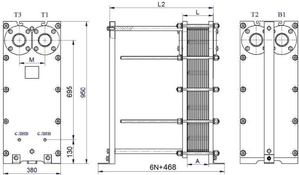
Рисунок 49- Двухходовой теплообменник ВТ-015 без циркуляционной линии
