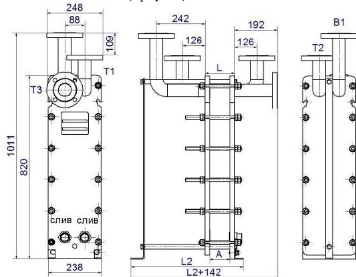
Рисунок 26- Двухходовой теплообменник ВТ-010, DN50 без циркуляционной линии
