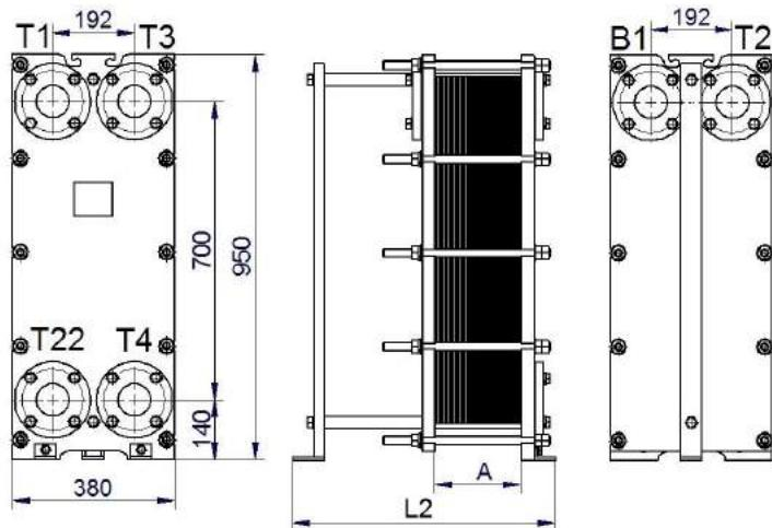
**Рисунок 56- Двухходовой теплообменник ВТ-015М, DN50 и DN 65 для двухступенчатой смешанной схемы горячего водоснабжения МГВ**
