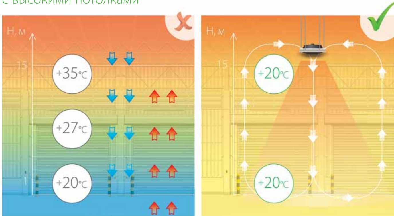
Распределение тепла в здании без использования дестратификаторов
